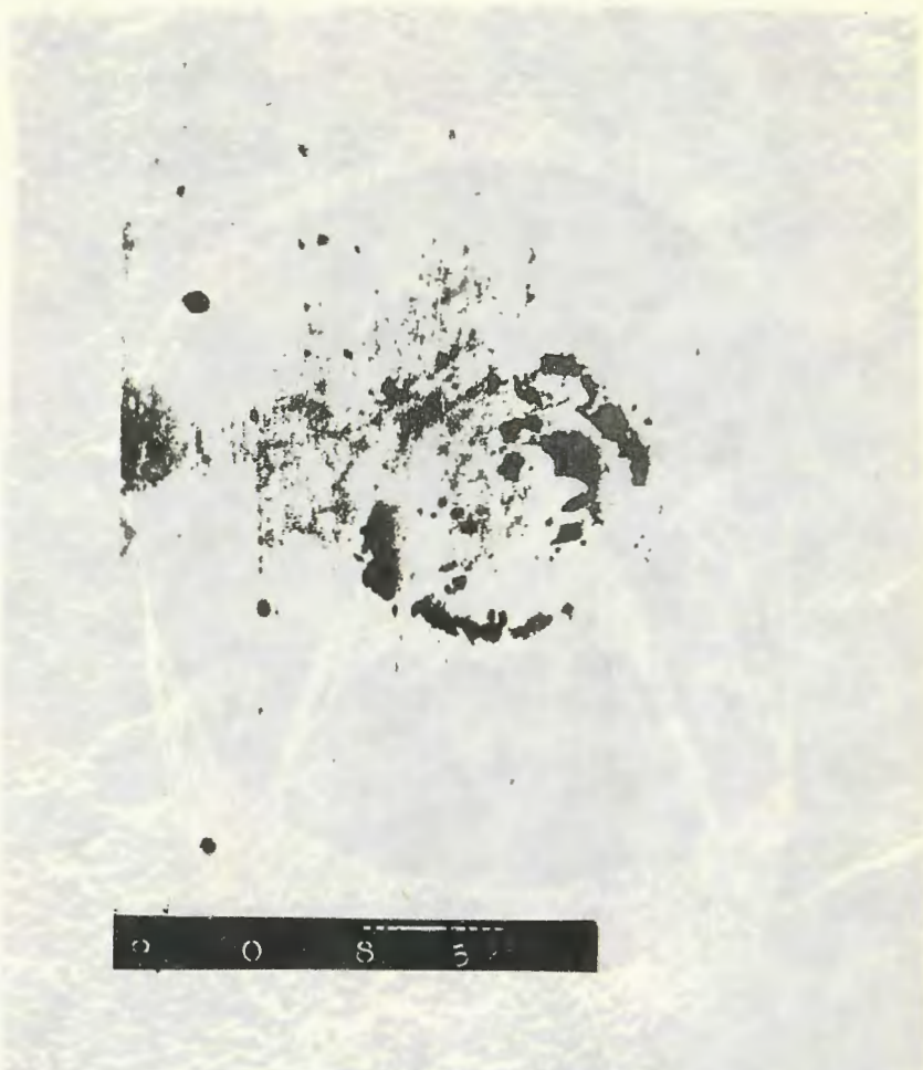
Рис.4 Микрофотография отпечатка на травленной поверхности германия (X 2000). Индентор из корунда.
